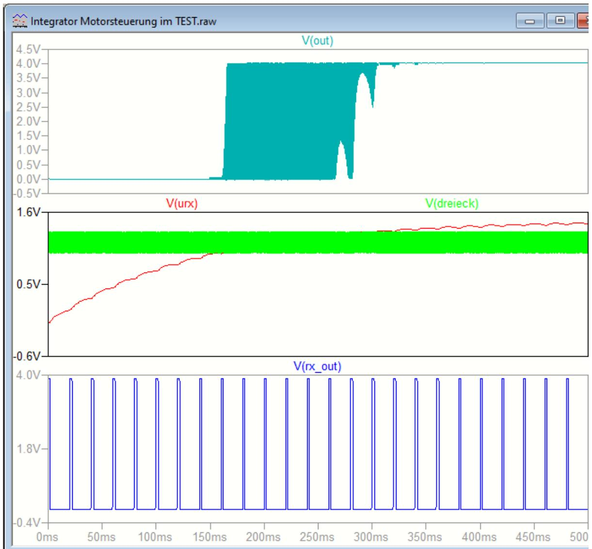
Die Ausgangs-Pulsbreite ist abhaengig vom Wert der Referenzspannung (integriert aus dem Empfaenger-Ausgangsimpuls) und kann von 0 bis 100% erzeugt werden.
